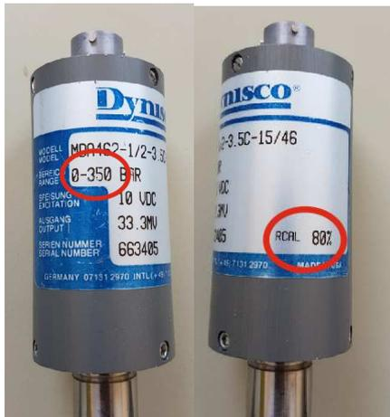
Im Beispiel hat der Sensor einen Messbereich von 350bar, sowie eine integrierte Kalibrierung bei 80%.
