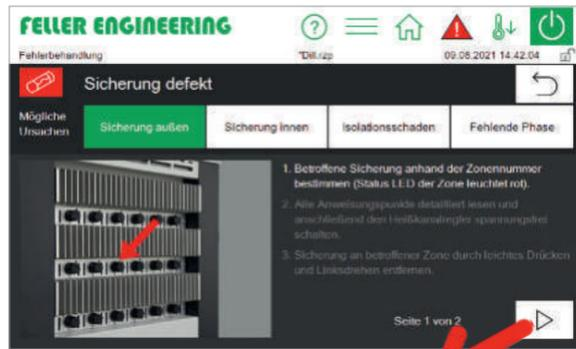
Beim Auftreten einer Störung erhält der Anwender in Wort und Bild eine exakte Anleitung, wie er bei der Störungsbehebung vorgehen muss. Durch Anklicken der Pfeilbuttons ◀ ▶ lassen sich die Anweisungen Schritt für Schritt darstellen.
