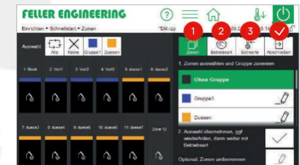
Der Schnellstart führt durch die wesentlichen Einstellungen (Gruppen, Betriebsart und Sollwerte), um den Regler bei einem Werkzeugwechsel schnell und sicher in Betrieb zu setzen.
