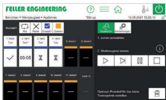
Der Werkzeugtest überprüft die Verdrahtung von Fühlern und Heizungen und ist insbesondere beim Einrichten eines neuen Werkzeuges sinnvoll.
