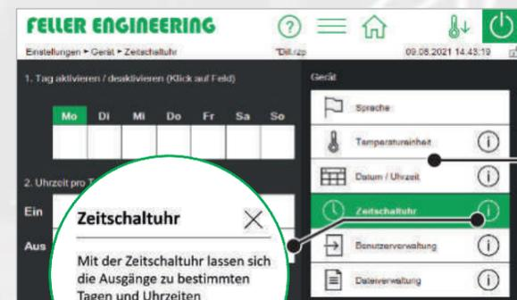
Mit der Zeitschaltuhr lassen sich die Ausgänge zu bestimmten Tagen und Uhrzeiten automatisiert ein- und ausschalten.
