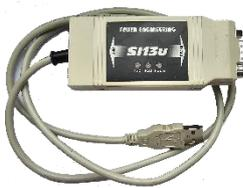
Die RS485 Schnittstelle des Konverters ist über eine 9pol. DSUB-Buchse an Pin 2 und 3 herausgeführt. Die Verbindung zu Feller Temperaturreglern mit RS485 über DSUB-Buchse kann bequem über ein Kabel vom Typ **AU067** hergestellt werden.
